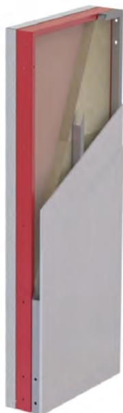
Le contropareti interne perimetrali prevedono la realizzazione di un tavolato verticale a gesso rivestito installato su supporto in acciaio, previa la posa in opera di materassino isolante in lana di roccia dello spessore di mm. 100 all'interno del profilo a "C" e a ridosso della soletta in calcestruzzo.
