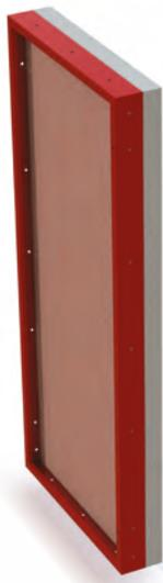
La struttura portante perimetrale ed, in certe situazioni, interna sono costituite da profili in acciaio caratterizzanti l'elemento parete. Elemento composto da un profilato a freddo a "C" (UNIEN10025 S235) ottenuto da nastro di acciaio gradualmente piegato attraverso coppie di rulli sino ad ottenimento della forma desiderata, o da pressopiegatura.
